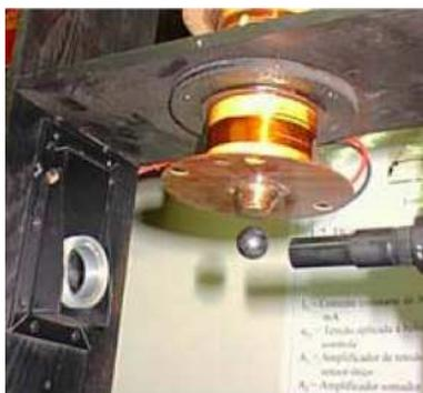
Figura 3: Detalhe do Levitador Magnético.
